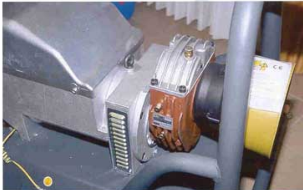
Das vorgeschaltete Übersetzungsgetriebe ist sehr einfach aufgebaut, robust und langlebig. Lediglich der Ölstand muss gelegentlich kontrolliert werden. Text und Fotos: Renfert-Deitermann
