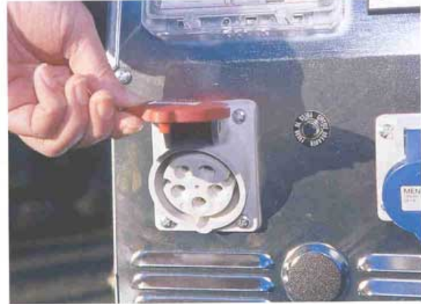
Je nach Geräteleistung werden die Aggregate mit 16- oder 32-Ampere-Steckdosen ausgestattet. Reine Wechselstrom-Aggregate produzieren nur 230 Volt.
